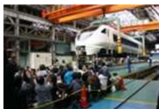
※大型クレーンによる車両の空中移動 （イメージ）
